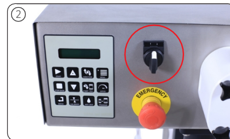
2 Tlačidlo v červenom kruhu slúži na nastavenie výšky plniaceho stroja. Keď nastavíte požadovanú výšku, znovu utiahnite skrutky, ako je vidieť na obrázku 1.
