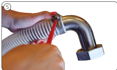
5 Namontujte hadicu na armatúru. Je dôležité namontovať hadicovú svorku za vyvýšeninu a potom skontrolovať, či hadica nie je prasknutá! Tip: Hadicu pred nasadením na potrubie zohrejte teplou vodou. Uľahčí to montáž.
