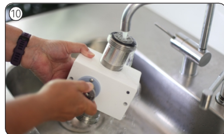
10 Opláchnite čerpadlo vodou a zároveň otáčajte spojkou. Tým sa med uvoľní a bude ľahšie otvoriť kryt čerpadla.
