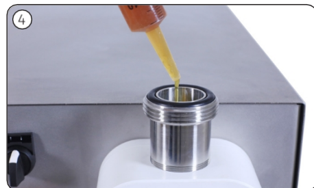
4 Pod kryt čerpadla umiestnite nádobu/misu. Zrieďte kryt čerpadla požadovanou látkou, ktorou ho chcete naplniť. Naplňte ho až po okraj armatúry.
