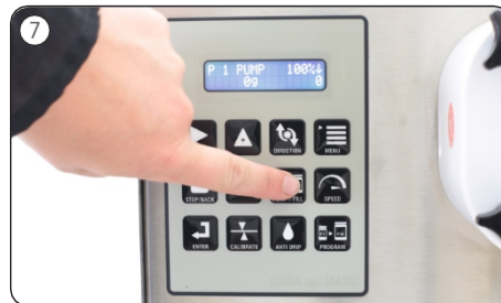
7 Stlačte tlačidlo [PUMP/FILL] a nastavte stroj na čerpanie. Čerpajte 1–2 sekundy a potom znovu naplňte telo čerpadla až po okraj.
