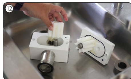
12 Vyberte voľné ozubené koleso a os, ktoré sú stále v puzdre čerpadla. Na uvoľnenie dielov môže byť potrebné dôkladné opláchnutie vodou.
