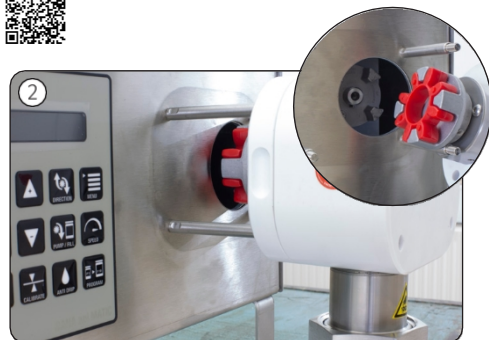
2 Namontujte skriňu čerpadla na stroj. Nezabudnite, že zuby spojky musia byť v správnej polohe, inak sa nedajú úplne nasadiť. Pred použitím sa uistite, že je stroj umiestnený na stabilnom podklade.
